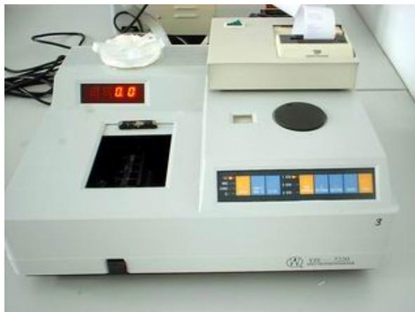
色皿表面的余液，然后将比色皿插入比色室里的卡座中，拉动卡座拉杆，将空白液的比色皿置于光路中。
